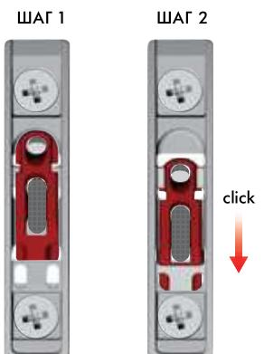
Полностью поднимите фасад, чтобы была возможность установить конечный элемент тросика в крепление на фасаде
