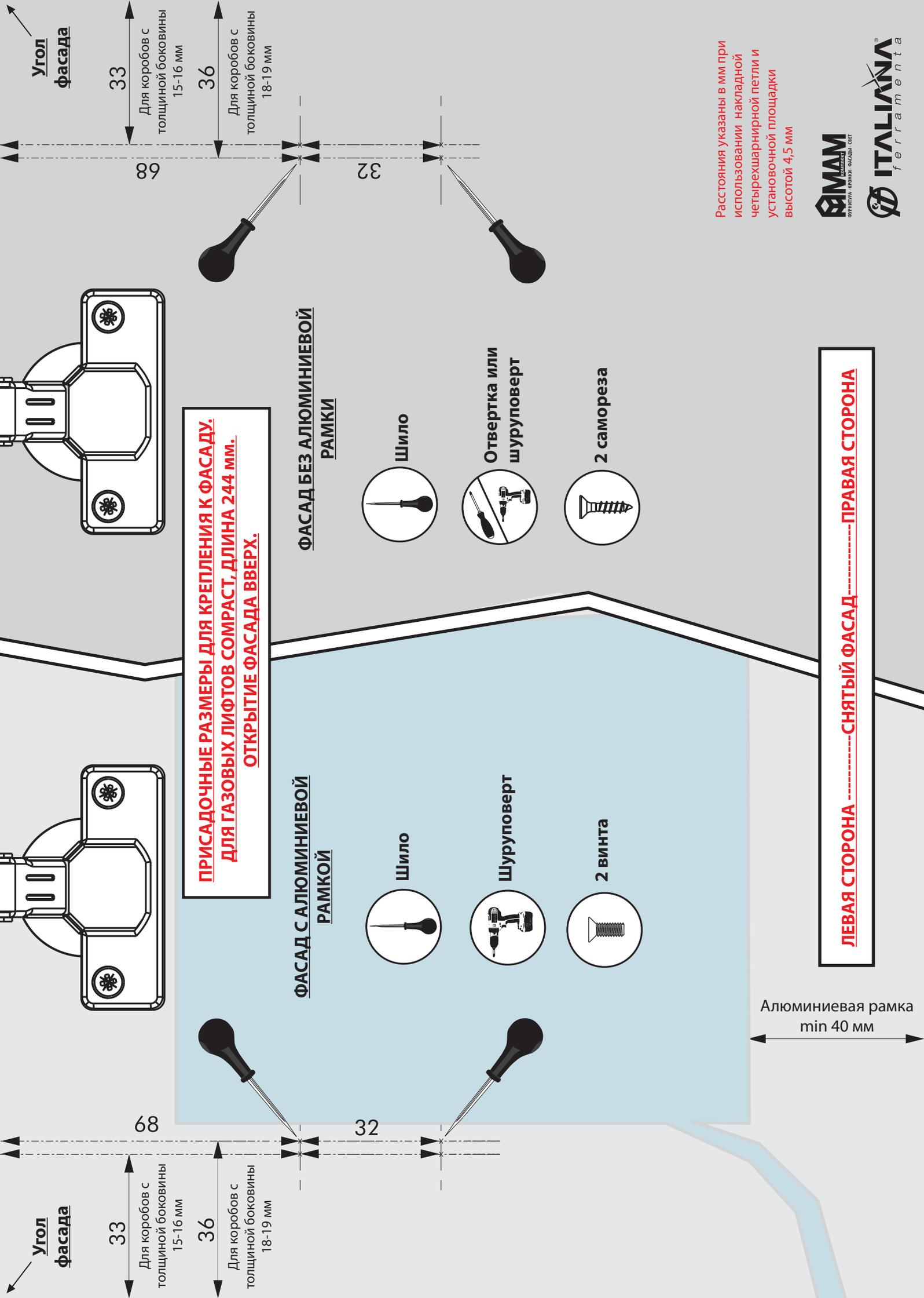
Расстояния указаны в мм при использовании накладной четырехшарнирной петли и установочной площадки высотой 4,5 мм
