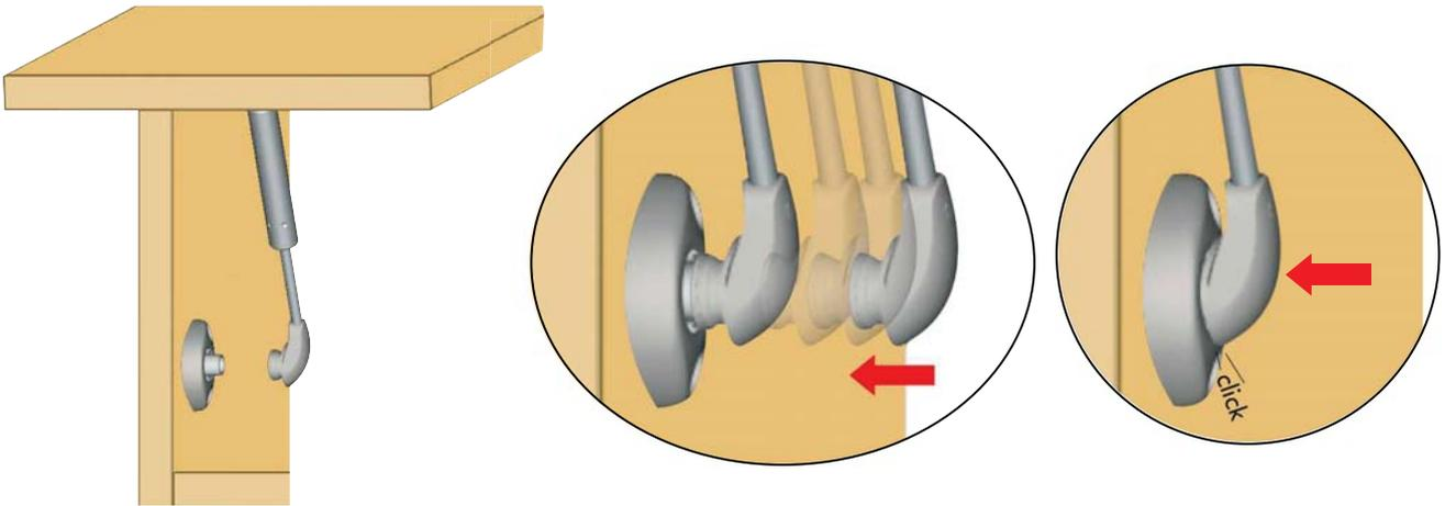
Установка лифтов COMPACT производится без инструментов
