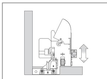
Регулировка по ширине (макс.  $\pm 1,5$  мм)
