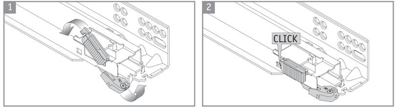
**Демонтаж адаптера для регулировки по глубине**
