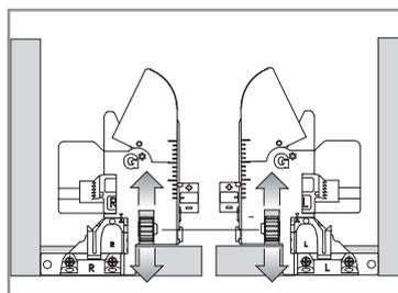
Регулировка наклона фасада (макс. +4,0 мм)
