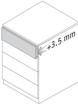
**Установка адаптера для регулировки по глубине**
