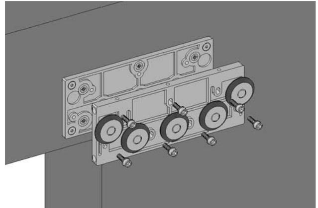
2. Установка ролика на монтажную площадку.
