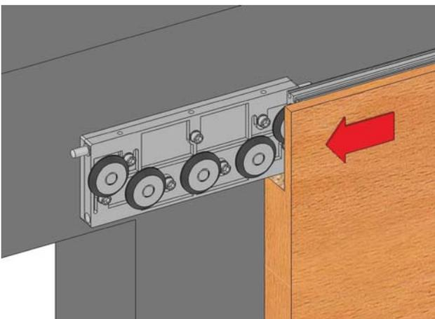
5. Установка направляющей на ролике.
