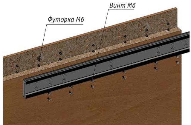
4. Установка направляющей в дверной массив.
