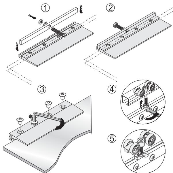
Установка роликов и стопоров
