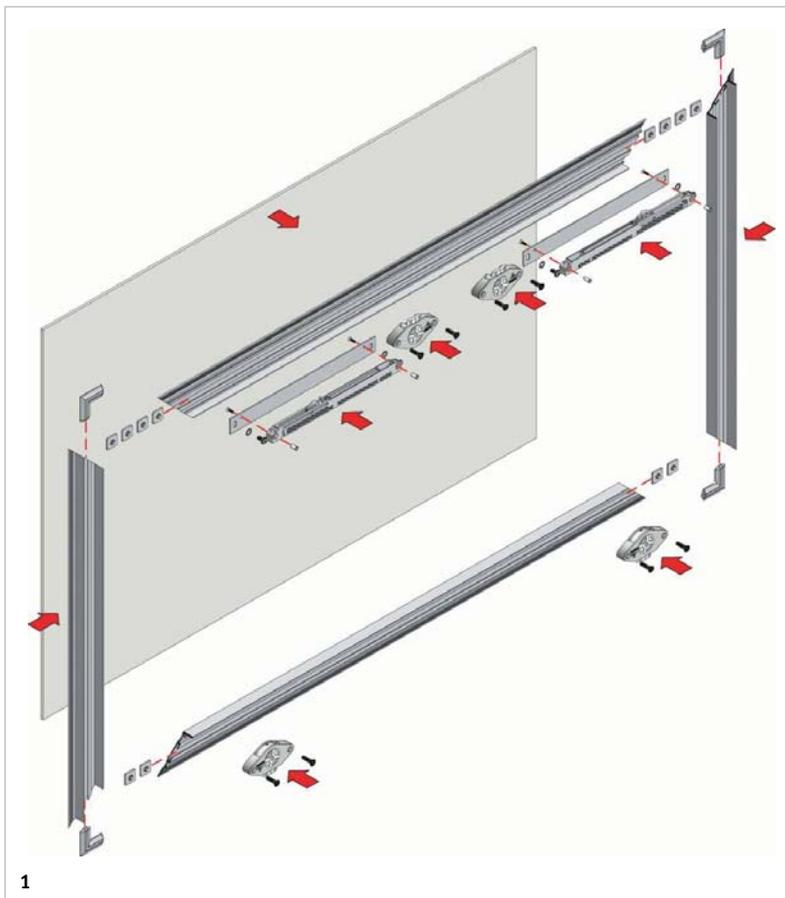
**1** Установите в горизонтальные профили монтажные планки, а затем прикрутите к ним ролики, ригели и доводчики согласно схеме.
