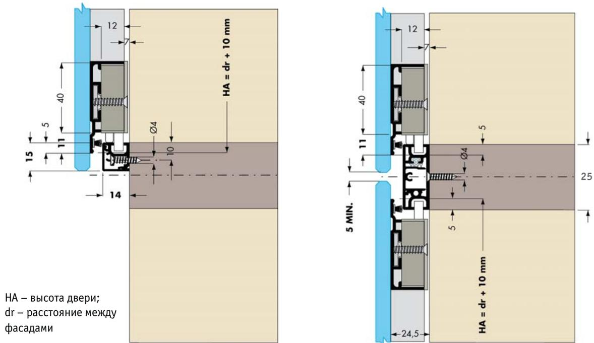
Пример фрезеровки деревянного фасада (доводчик, верхний ригель, нижний ролик)
