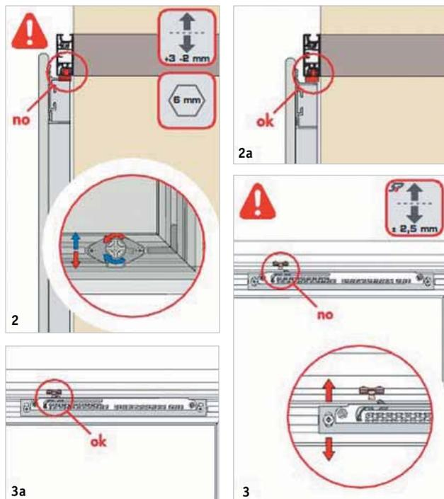
**2, 2a** Установите фасад на направляющую, при необходимости выполните регулировку по высоте.
