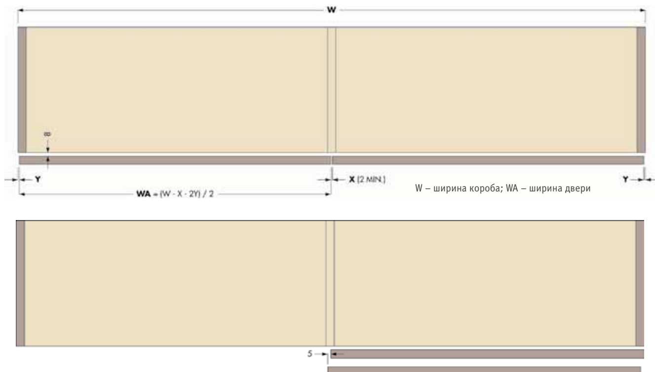
Схема расчета ширины дверей для компланарной системы PS40, Cinetto
