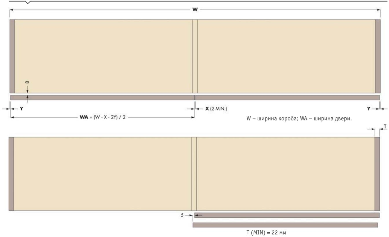
Схема сверления и фрезеровки отверстий на фасадах
