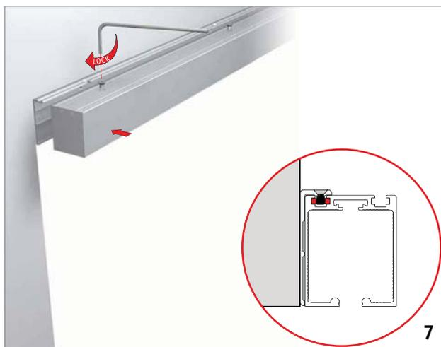
**1** Установка системы со стопором (**1a**) или доводчиком (**1b**).
