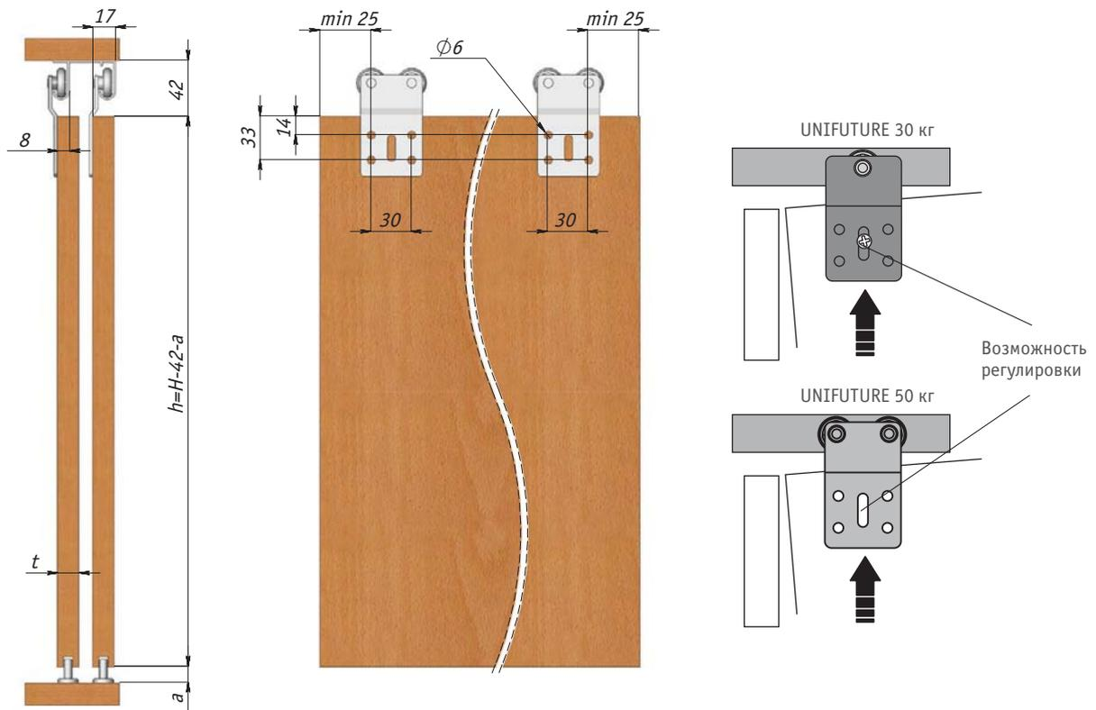
Схема крепления верхней направляющей и установки двери в системе UNIFUTURE
