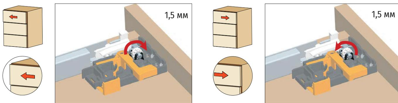
**Регулировка по глубине**
