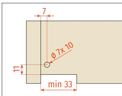
**1071000010100** Комплект фиксаторов для направляющей скрытого монтажа FUTURA SMOVE с регулировкой по высоте
