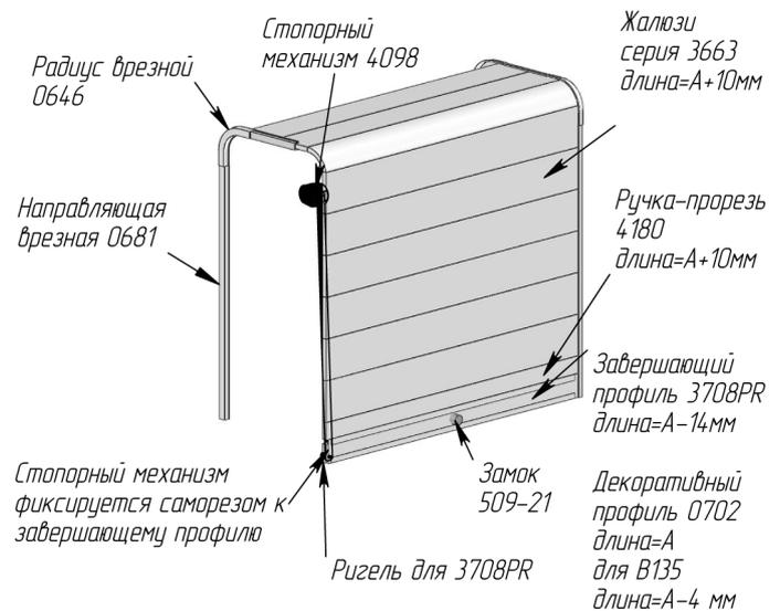
Размер паза под врезную направляющую, врезной радиус и стопорный механизм
