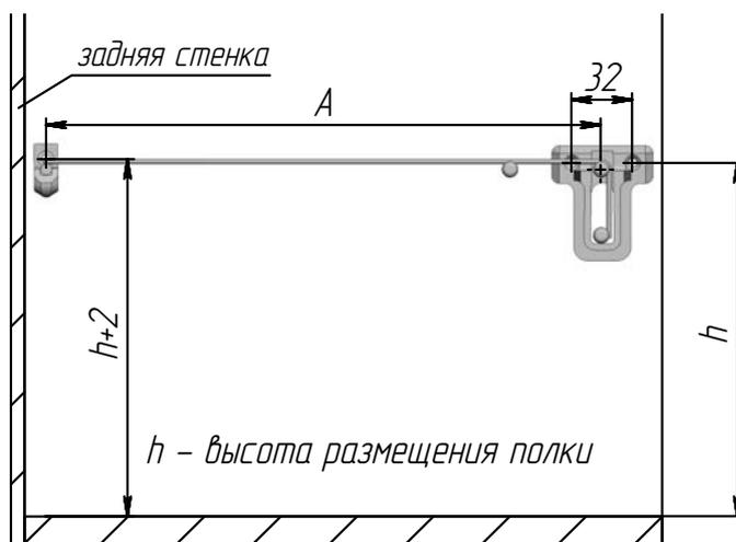
Элементы для установки полки в корпус с креплением к задней стенке
