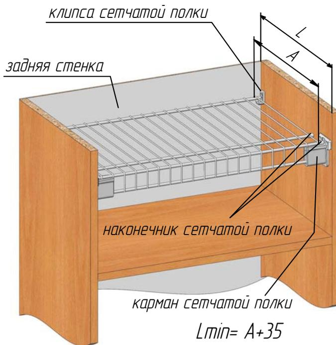
Схема расчета и установки сетчатой полки к боковине
