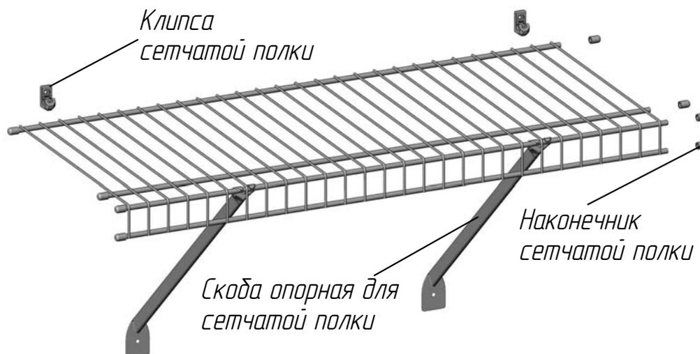
Схема для расчета и установки полки к стене
