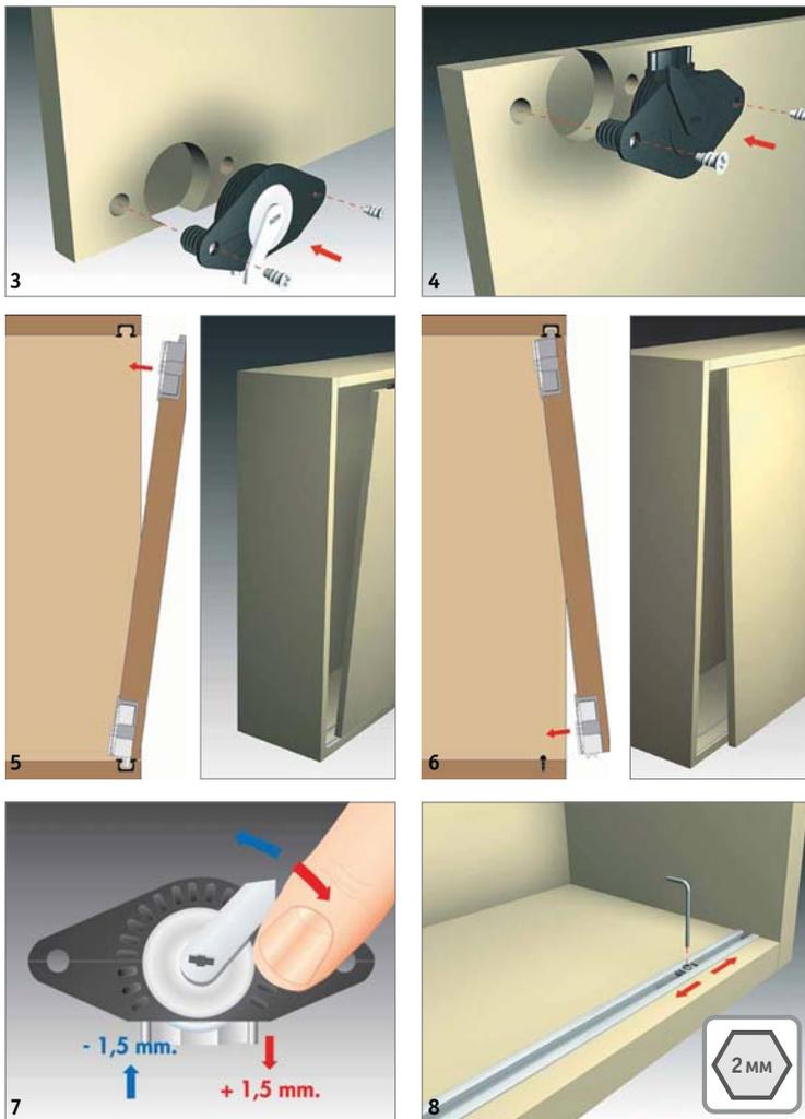
**Система с регулируемыми роликами для дверей из ДСП**
